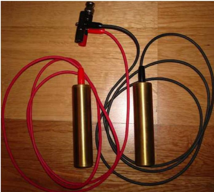
A gauche : 2 électrodes de cuivre connectées avec des fiches bananes bon marché sur un adaptateur BNC / double-fiche-bananes (photo de gauche). Ces adaptateurs sont disponibles sur <http://www.jlelectroniq.com/mounel/sono/fiche1.asp?searchFor=KKCBNC35>.
