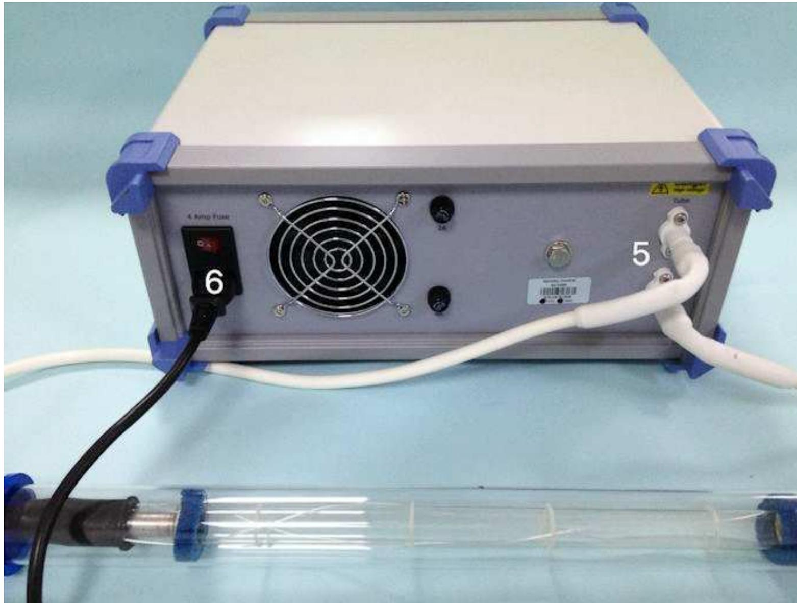
**5** - Connectez votre **Tube** à plasma sur les connectiques hautes tensions à l'arrière.
