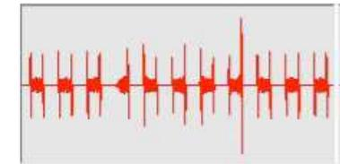
**H-Bomb sinusoidal:** Mod F2 w/F1 (AM DSB,  $F2 = 11xF1$ ).
