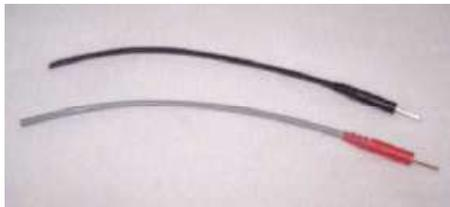
Pour les composants enfichables, munissez-vous de deux câbles munis d'une fiche banane à l'une de ses extrémités (comme sur la photo). Dénudez les autres extrémités et fixez-les sur les supports des plaquettes TENS (vous aurez peut être besoin d'un tournevis).
