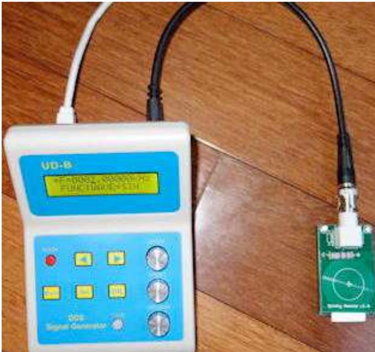
Pour simplifier les connexions, plutôt que d'utiliser le câble droit, il est possible d'utiliser un simple connecteur BNC mâle-mâle, également appelé "coupleur". Grosso modo, ce coupleur BNC assure une connexion directe de bout en bout. Ceux-ci fonctionnent aussi très bien pour l'UDB1108S.
