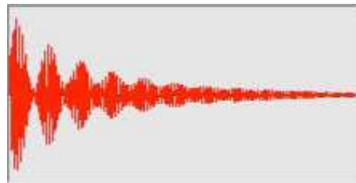
**Damped sinusoidal:** Mod F2 w/F1 (AM DSB,  $F2 = 11xF1$ ).
